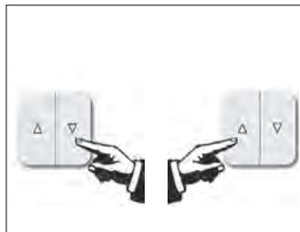
Het scherm met de ▼ (OMLAAG-toets) uitvaren tot het vergrendelings-uitvalprofiel kan worden bediend.
