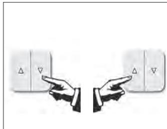
Die Markise mit der ▼ (AB-Taste) ausfahren, bis die Ausfallprofil-Arretierung bedient werden kann.
