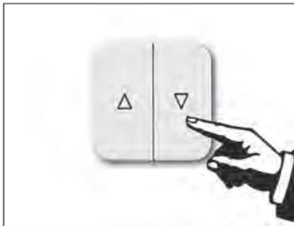
Die Markise mit der ▼ (AB-Taste) vollständig ausfahren.
