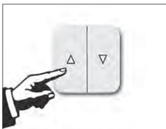
Fermer le store dans l'arrêt de la barre de charge en appuyant sur la touche HAUT ▲ jusqu'à ce que le moteur s'arrête automatiquement.
