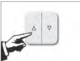
Die Markise mit der ▲ (AUF-Taste) in die Ausfallprofil-Arretierung einfahren, bis der Motor selbständig abstellt.
